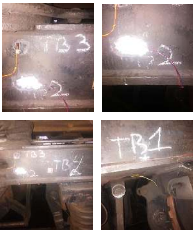
Рис. 5 – Приклади встановлення тензорезисторів на рамі візка тепловозу 2ТЕ10М
